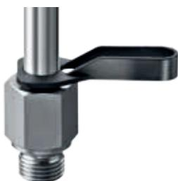
Для разъединения необходимо вставить разъединительную втулку или клещи в быстроразъемное соединение до упора и, удерживая в этом положении, вынуть трубу или переходник.
