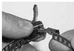
Установите рычажок в положение «открыто», придайте концу ленты форму, соответствующую кривизне замка. Протяните свободный конец под язычком и через прорезь так, чтобы конец выступал за пределы корпуса замка.
