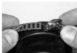
Расположите хомут на объекте. Вставьте свободный конец ленты поверх крючков и под винтом с выходом за пределы корпуса винтового замка. Зацепите крючки за перфорированные отверстия в максимально плотно затянутое положение.
