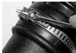
Затяните хомут с помощью отвертки или шестигранного ключа.
