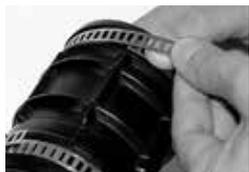
Определите длину хомута, например, оберните лентой зажимаемый объект и прибавьте приблизительно 50 мм.
