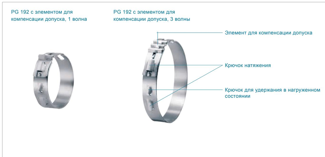
Элементы для компенсации допуска: обеспечивает компенсацию допусков соединяемых компонентов и температурное расширение материалов
