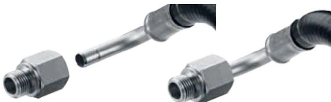
Для соединения необходимо вставить трубу или вставной штуцер с пазом в быстроразъемный соединитель до щелчка. Мы рекомендуем проверить надежность установки, попробовав вытянуть вставленную трубу рукой. Фиксация трубы или вставного штуцера в быстроразъемном соединителе происходит за счет имеющегося в трубе паза. Ответный элемент в быстроразъемном соединении и пружинное кольцо позволяют сэкономить пространство и обеспечивают минимальный диаметр быстроразъемного соединения.
