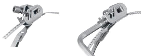
Затяните хомут с помощью торцевого шестигранного ключа 5 A/F. Эта система условно пригодна для мягких и эластичных компонентов.
