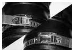
Расположите хомут на объекте. Слегка прижимая свободный конец ленты, двигайте рычаг трещетки вперед-назад до достижения затянутого положения хомута. После этого закрепите рычаг, опустив его вниз до упора. Защитная выемка не позволяет замку самопроизвольно открыться.
